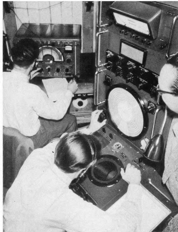
Bild 1. Bedienungsplatz des neuen Kurzzeit-Peilers von Telefunken auf dem Versuchsfeld bei Ulm
