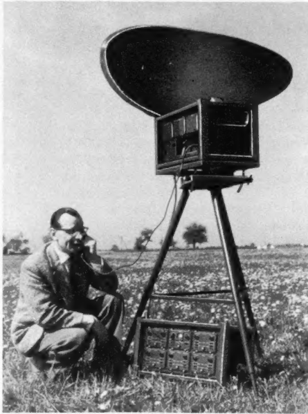
7-GHz-Kleinfunkbrücke im Einsatz. Oben H-Gerät mit Sender, Empfänger, Dipolantenne und Hohlspiegelreflektor, unten M-Gerät mit maximal sechs Modulatoren, Meßverstärker, Meßfeld, Fernsprechan schlüssen und Netzteil
